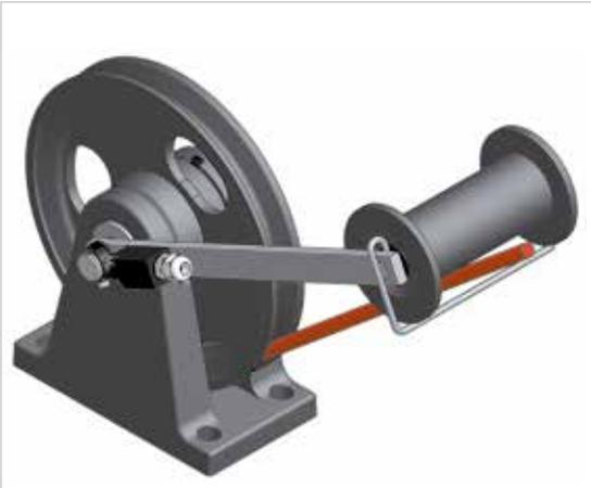
Seilrollen mit Bock WZ 21 - WZ 26 lassen sich mit Schlaffseilschalter ausrüsten, wenn z.B. Anbau an der Seilwinde nicht möglich. Ausführungen für Boden-, Wand- und Deckenbefestigung lieferbar
