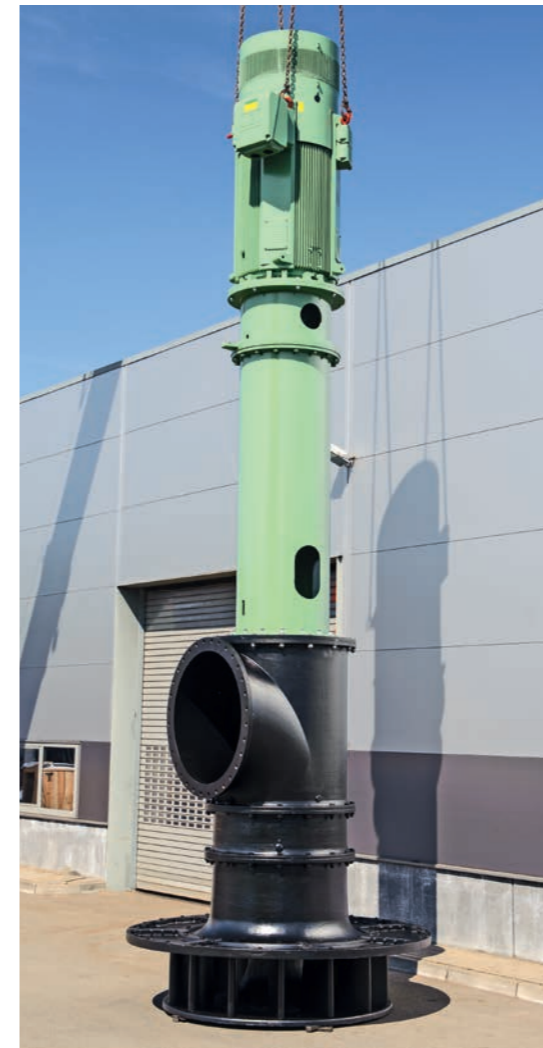
Großpumpe für das Schöpfwerk Dahme VP 1200 Vertikale Propellerpumpe 4.000 l/s 3,4m 220 kW
