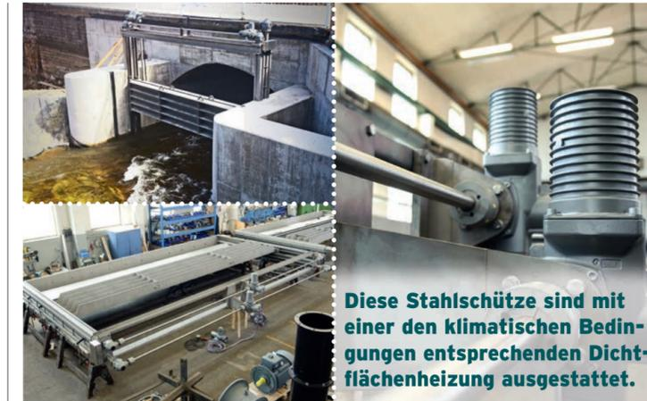
Diese Stahlschütze sind mit einer den klimatischen Bedingungen entsprechenden Dichtflächenheizung ausgestattet.
