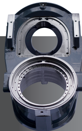
Werkzeugkonsole Breite: 620 mm Höhe: 920 mm Gewicht: 520 kg
